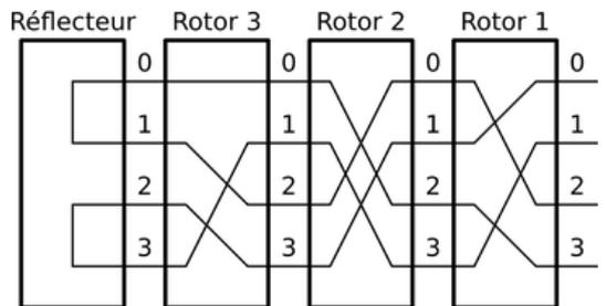
a) On suppose qu'on utilise deux rotors seulement et qu'ils sont fixes. On représente chaque rotor par une liste associant chaque lettre de départ avec une lettre d'arrivée. Voici la description de 2 rotors et d'un réflecteur :
