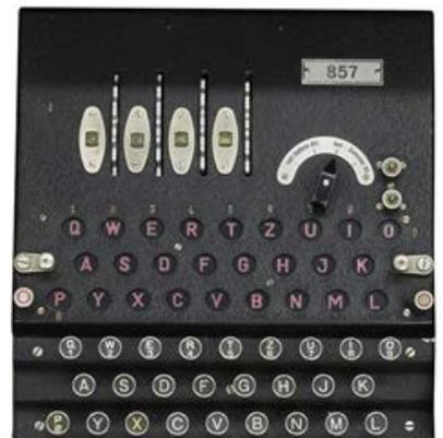
La machine utilise des rotors (visibles sur la photo) qui relient chacun électriquement une lettre en entrée avec une lettre en sortie.
